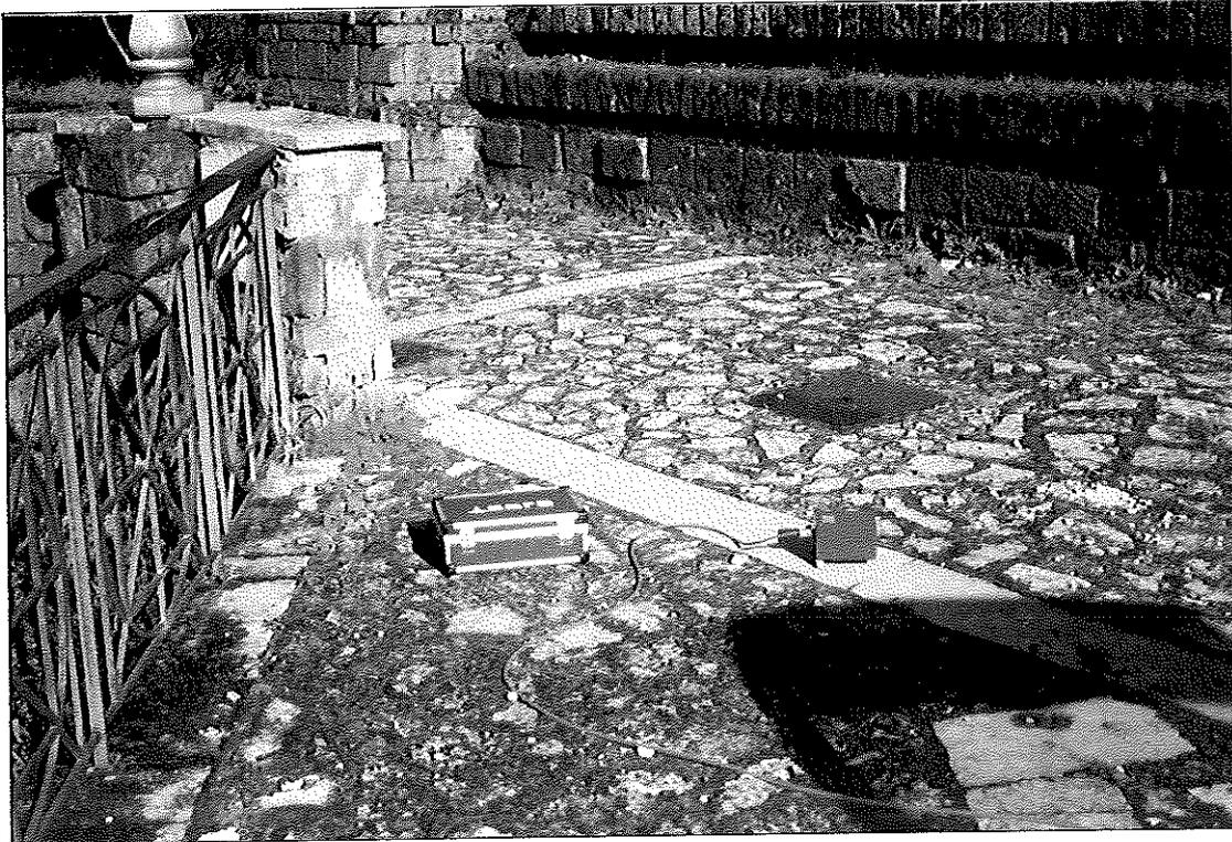
**Figura 1- Esecuzione Prospezione HVSR V1 - Loc. Centro Storico**
